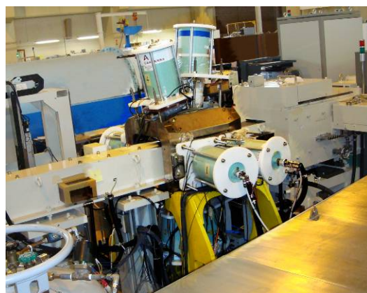
図 1 JRR-3 に設置された MPGA 装置 クローバー型検出器 8 台及び BGO 検出器から構成される。右側が炉心、左側がビームストップ側。
