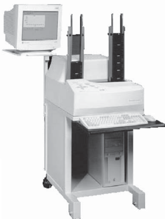
5XLBシリーズ: 低バックグラウンド \alpha / \beta 自動計測システム
