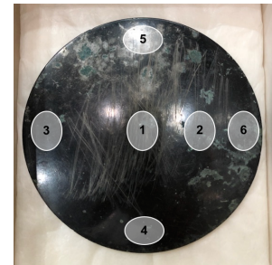
Figure 1: 銅鏡におけるミュオンの照射位置
