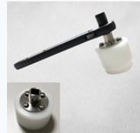
キャップ締め込み治具 規定トルクで絞めこむ治具
